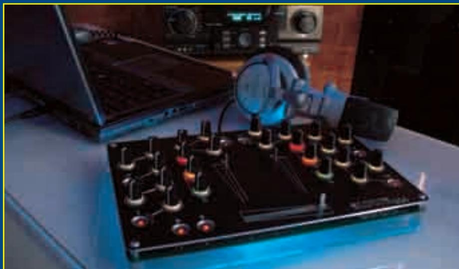
▲ Un progetto Open Hardware: Aurora 224, un mixer per DJ a due canali con 24 potenziometri analogici, 3 slider e diversi LED di segnalazione.
